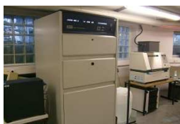
Cámara de test Q-Sun Xenon (pruebas climatológicas aceleradas)
