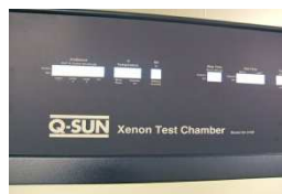
Cámara de test Q-Sun Xenon (pruebas climatológicas aceleradas)
